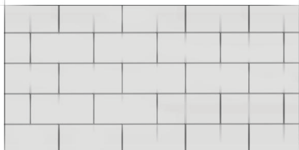
Prawidłowy sposób układu spoin pomiędzy płytami izolacyjnymi
