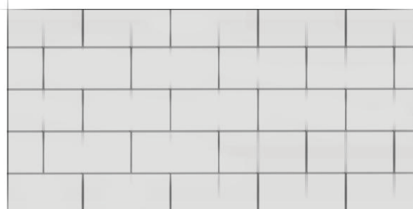
Prawidłowy sposób układu spoin pomiędzy płytami izolacyjnymi
